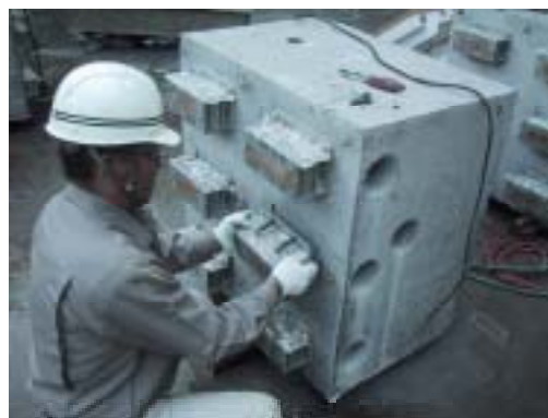
ボス供試体及び比較用コア供試体採取状況
