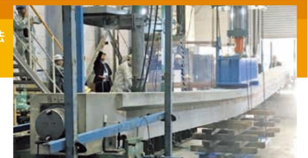
高強度コンクリートを用いる「ダックスビームHC工法」は、「より高品質で耐久性の高い製品をリーズナブルな価格で市場に提供する」ことを目指し、さらなる改良にチャレンジするものです。PC低桁高橋における必要かつ最適な圧縮強度の設定、自己収縮の低減、蒸気養生期間も含めた製作日数の短縮、工事費のさらなる削減を主な改良事項としており、2019年度内の実用化を目指しています。
