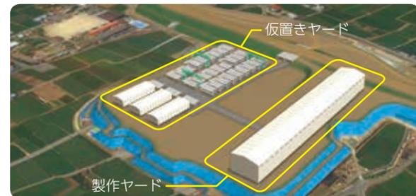
架設現場まで約300mの場所に製作ヤードを確保し、PC箱桁のセグメントおよそ1,100個の製作を開始。製作は天候の影響を受けない製作ヤードの上屋テント内にて実施。粉塵の拡散・騒音を防止することで、学校や茶畑などの周辺環境にも配慮
