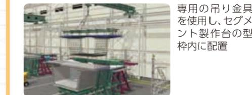
専用の吊り金具を使用し、セグメント製作台の型枠内に配置
