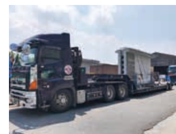
プレキャスト製品を運ぶ大型車両
