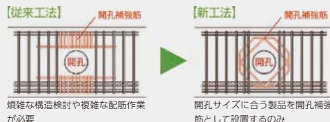
図3 開孔部の補強方法比較
