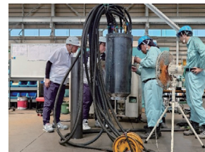
パイププレートレミ性能試験
