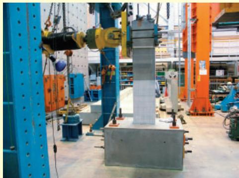
制震建物を設計する場合、時刻歴応答解析が義務づけられ、性能評価を受け、大臣認定の取得が必要となります。PC造制震建物をより合理的に設計するためには、PC鋼より線を使用した梁の大変形時の構造性能を明らかにする必要があります。そのため、当社の技術研究所にて、PC鋼より線および普通鉄筋を配筋した5体の梁試験体を用いて、水平力による正負交番載荷実験を行い、その構造性能を調べました。
