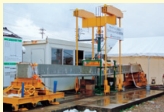
プレテンション方式PC桁の載荷試験
