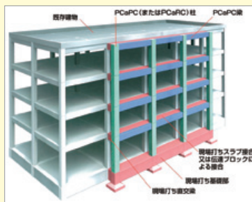
ピーエス三菱PCaPC外付けフレーム耐震補強工法
