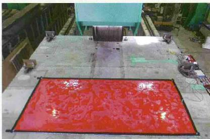
※6hの水張り試験で下面に漏水なし
