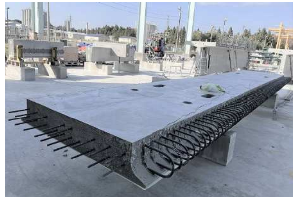
写真-1 スチームレスプレキャストコンクリートで製造したプレキャストPC床版試験体
