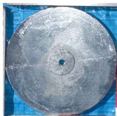
流電陽極材(防食亜鉛) φ110mm、t=5mm
