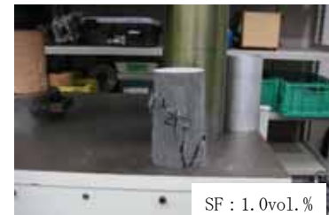
写真-4 破壊状況
