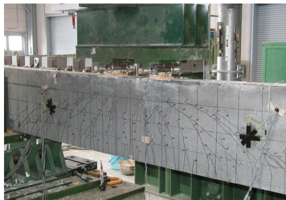
写真-3 せん断破壊実験状況
