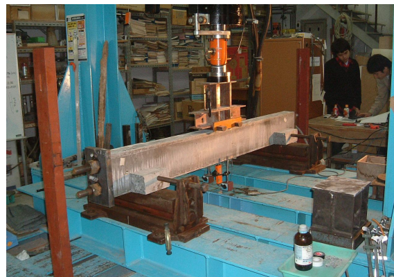
写真-4 疲労実験状況
