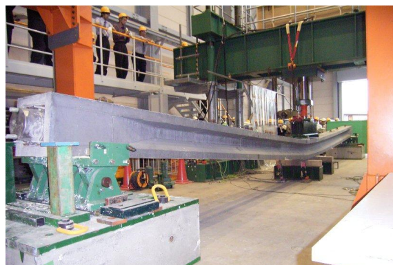
写真-2 曲げ破壊実験状況
