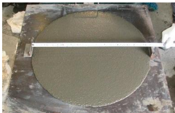
写真-1 材料試験状況(スランプフロー試験)
