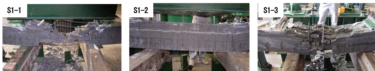
写真-1 破壊状況
