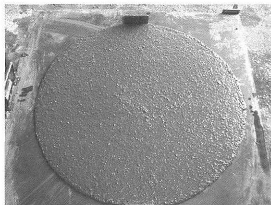
写真-1 高強度繊維補強モルタル
