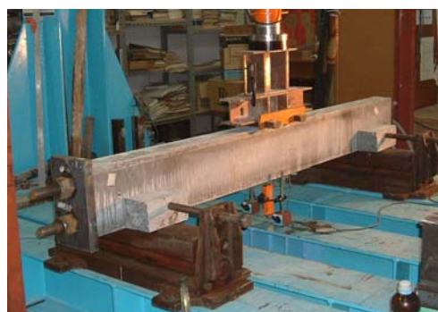
写真-3 疲労実験状況
