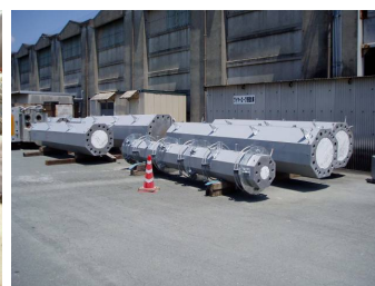
写真-5 完成したセグメント
