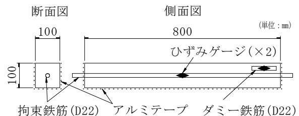
図-4 収縮応力試験の供試体
