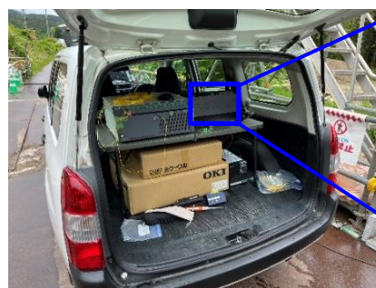
写真-5 SmART ストランドを用いたひずみ計測の状況
