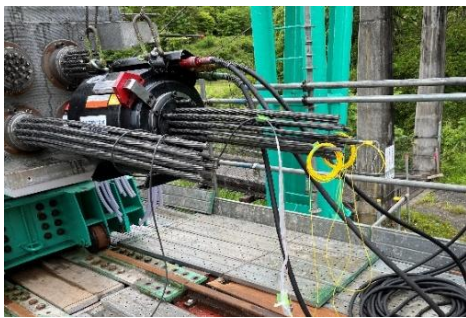
写真-5 SmART ストランドを用いたひずみ計測の状況
