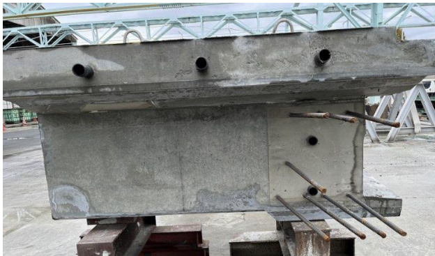
写真-4 過密配筋部における充填状況
