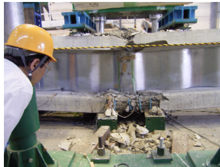
主桁供試体破壊状況
