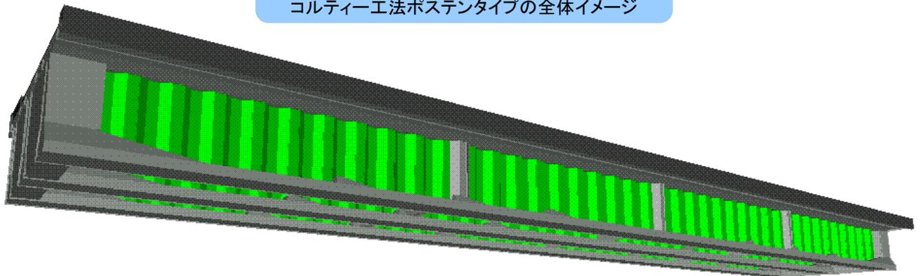
波形鋼板ウェブPCT桁橋の実用化のために、桁長23.8mの実物大主桁供試体を用いた、せん断載荷試験および曲げ破壊載荷試験を行い、波形鋼板ウェブPCT桁の力学的特性、破壊性状等を確認しました。この実験により、波形鋼板ウェブPCT桁橋の力学的特性、破壊特性などを確認しました。
