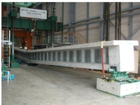
主桁供試体破壊状況
