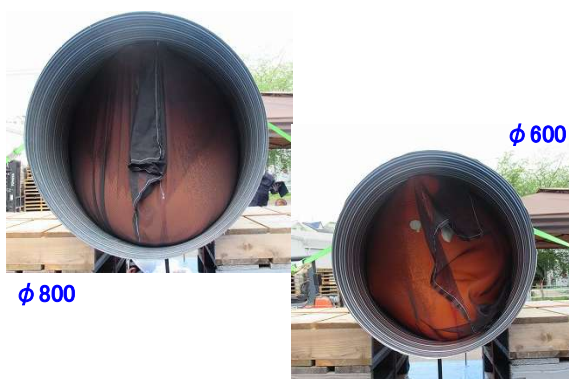
ウレタン注入試験(ボイド管径φ800とφ600)
