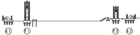
STEP 2 : PC 桁張出し架設 (P1側)
