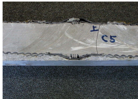
写真 - 19 グラウト後の状態
