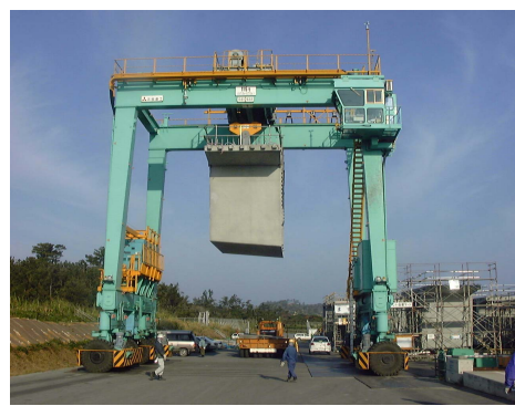
写真 - 2 トランスファークレーン
