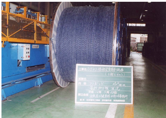
写真 - 14 P C 鋼材(エポキシ樹脂塗装)
