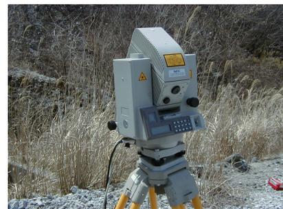
写真 - 3 ノンプリズム測距測角装置
