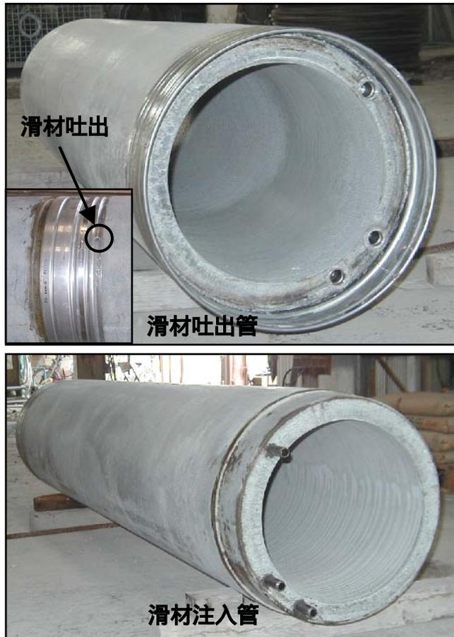
写真 - 9 スーパーマイクロ工法用管(トリプル管)
