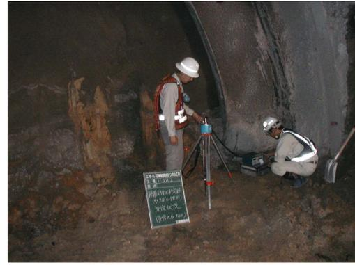
写真 6 支保工脚部地山支持力試験
