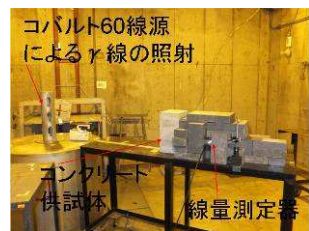
写真-1 遮へい性能確認実験状況
