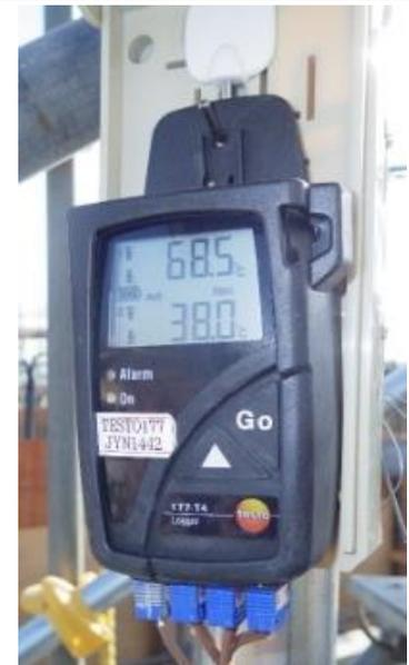
写真-2 コンクリート温度実測状況
