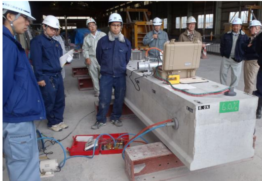
写真-1 表層透気性に関する調査状況
