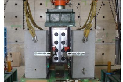
写真-2 押抜き試験状況
