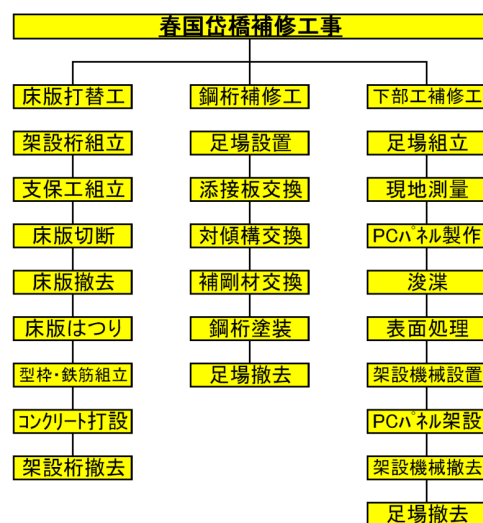
図-1 施工方法フローチャート
