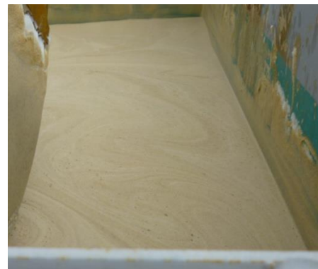
写真-5 気泡混合後状況
