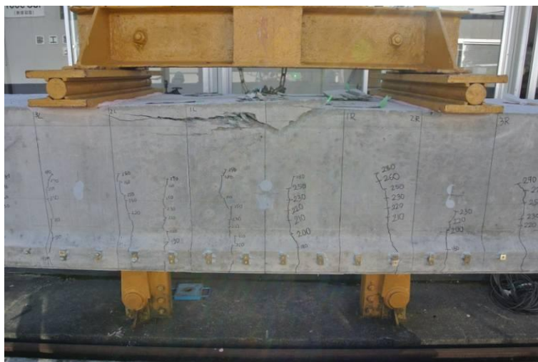
写真-2 純曲げ区間の破壊状況
