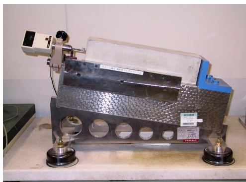
写真-1 乾燥収縮試験の状況
