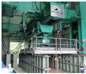
写真-2 輪荷重疲労載荷試験
