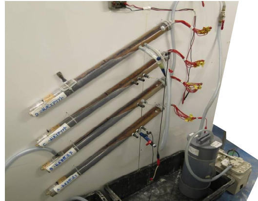
写真-2 \text{LiNO}_2 水溶液注入状況
