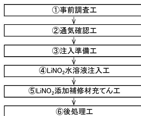
図-1 本補修工法の施工フロー
