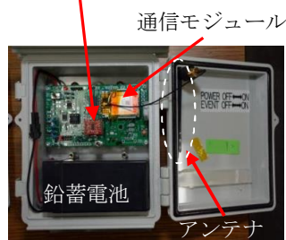
写真-2 のり面センサーの内部
