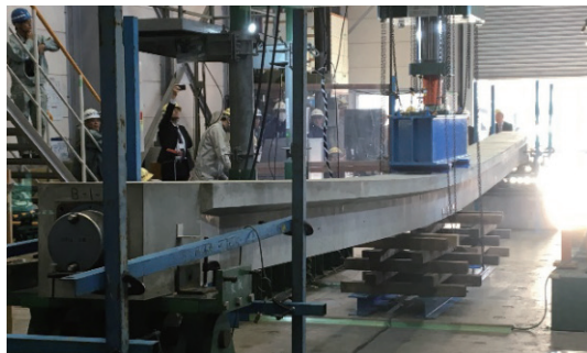
写真-1 曲げ載荷状況
