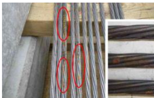
写真-5 未防錆 PC 鋼材 (PN-5)
