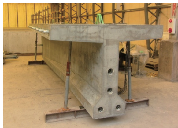
写真-1 脱枠後の状況
