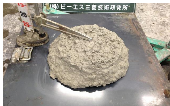
写真-1 フレッシュコンクリート試験状況
