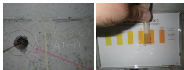
写真-6 塩化物イオン測定
