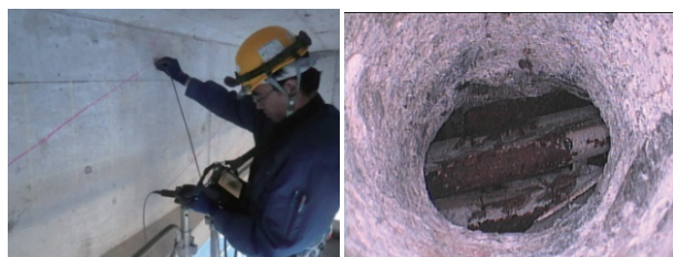
写真-4 φ26削孔+CCDカメラ
