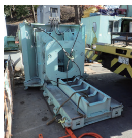
写真-3 アクロバットジャッキ
