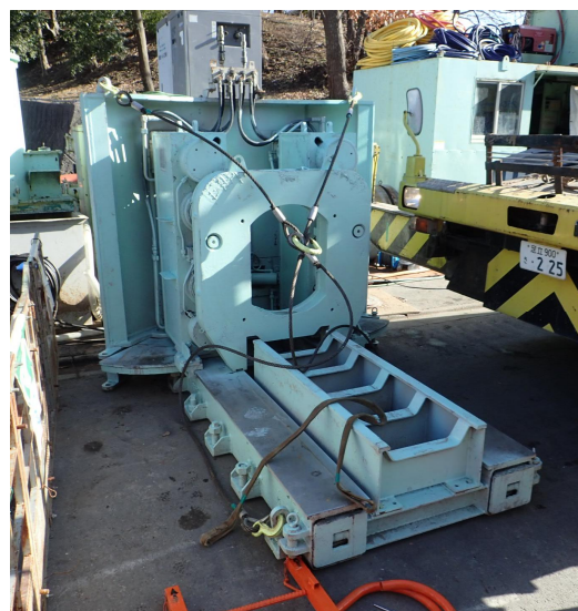
写真－3 アクロバットジャッキ
