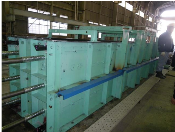
写真-3 標準柱型枠設置状況
