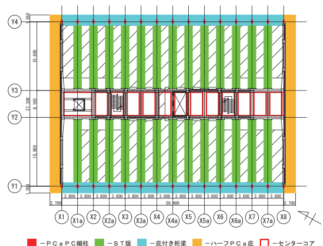
図-1 基準階伏図（PCa 部材配置）
