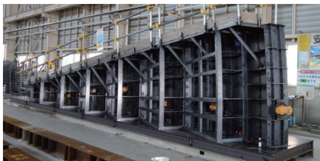
写真-3 床版の鋼製型枠
