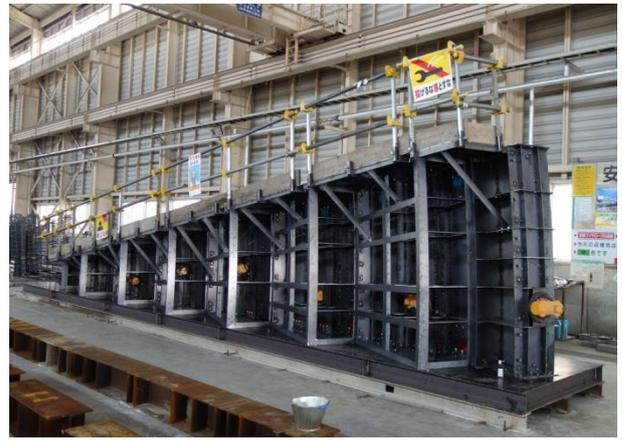
写真-4 床版の鋼製型枠
