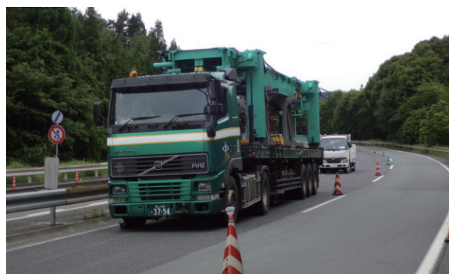
写真-4 架設機の運搬状況
