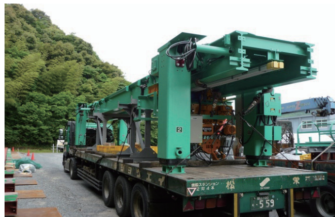
写真-3 架設機の運搬状況
