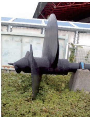
写真-1 横浜港のスクリューパイル
