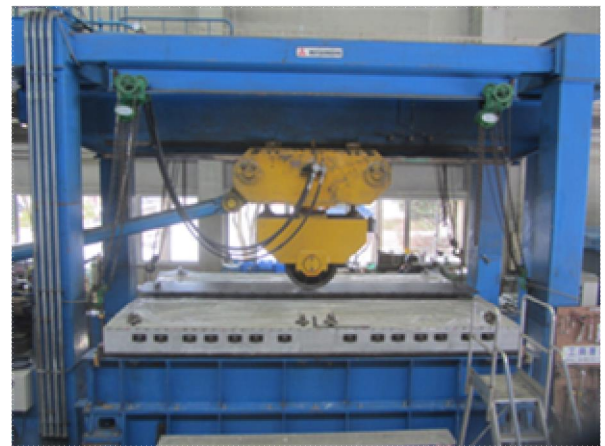
写真-4 輪荷重走行試験状況
